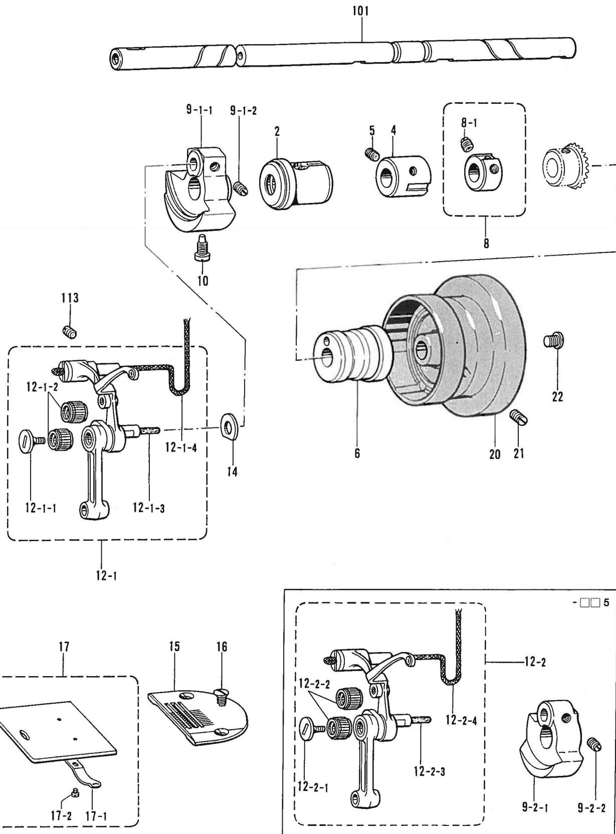
C. 上軸天ビン関係 / Upper shaft and thread take-up mechanism / Obere Welle und Fadenabnahmeverrichtung /
