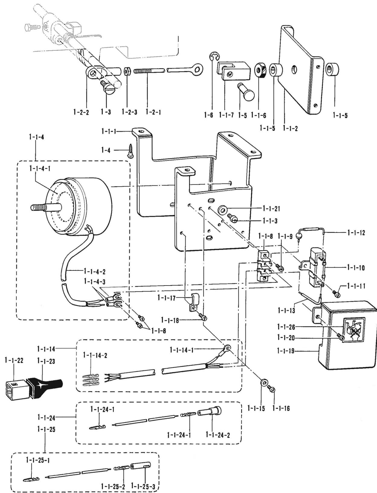
W1. 電磁押工上部関係/Presser foot lifting solenoid set/Solenoidsatz für die Anhebung des Stoffdrückerfußes/
