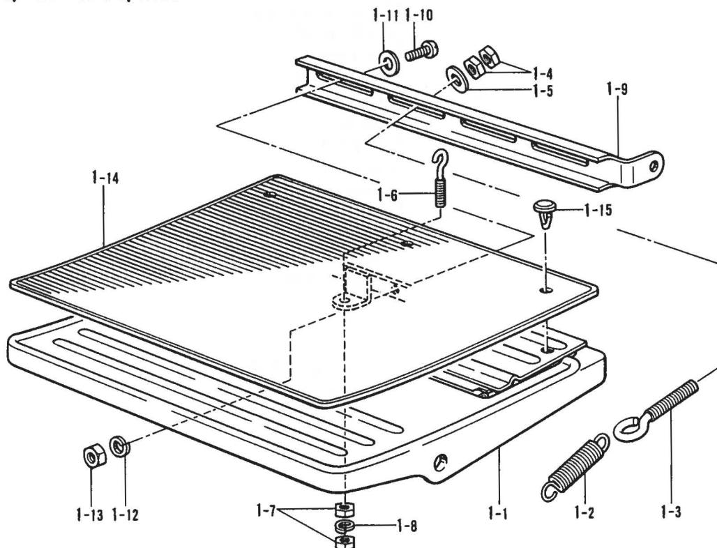
Y4. 踏ミ板関係 / Foot switch pedal mechanism / Fuß betätigung /
