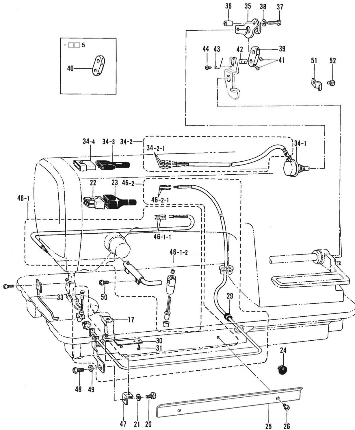
V. 布制御関係/Cloth control system mechanism/Stoffführungs vorrichtung /
