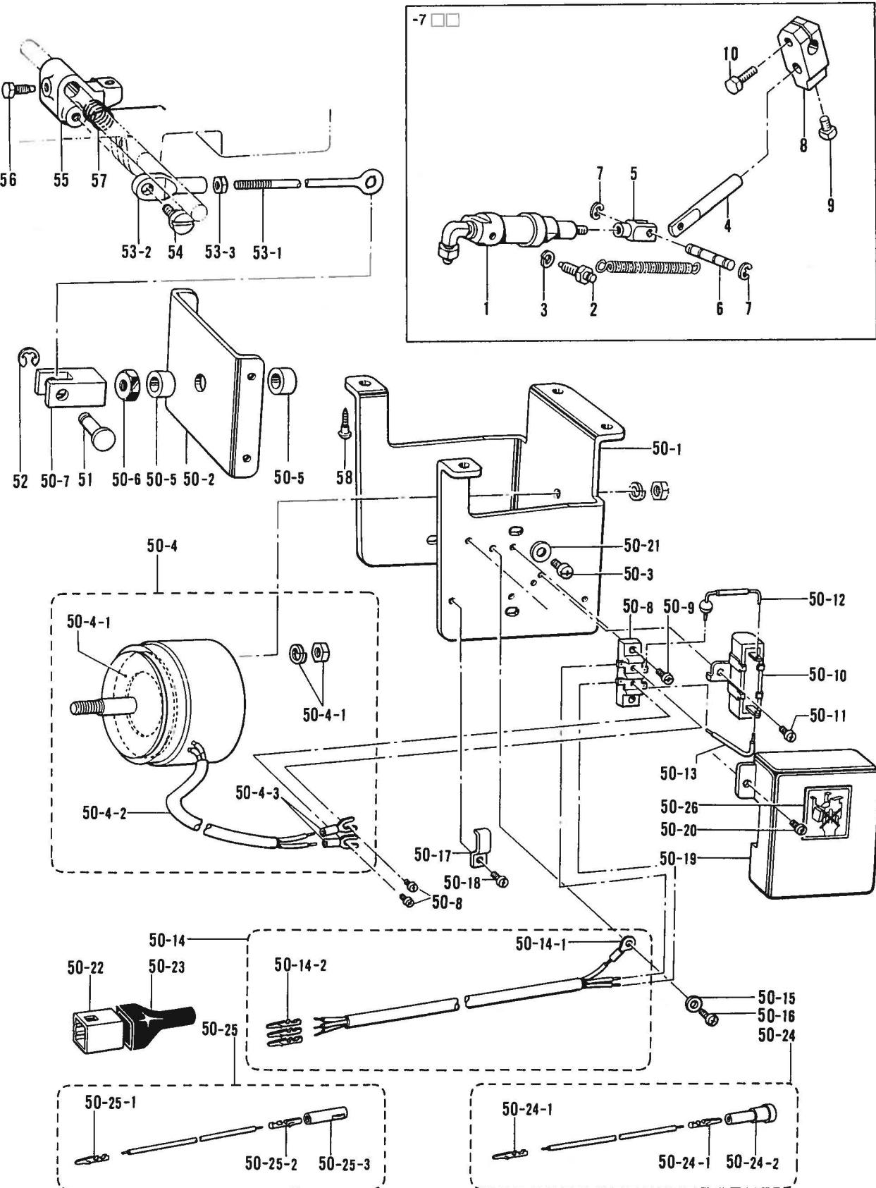
G. 押工上ヶ関係/Work clamp lifter mechanism/Stoffhalterhebervorrichtung/
