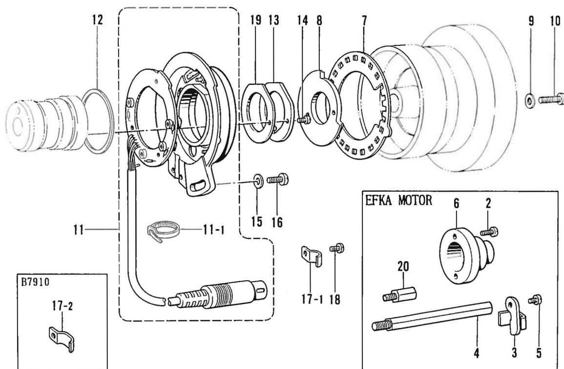
T. 逆転スイッチ関係/Quick reverse switch mechanism/Umkehrschalter/
