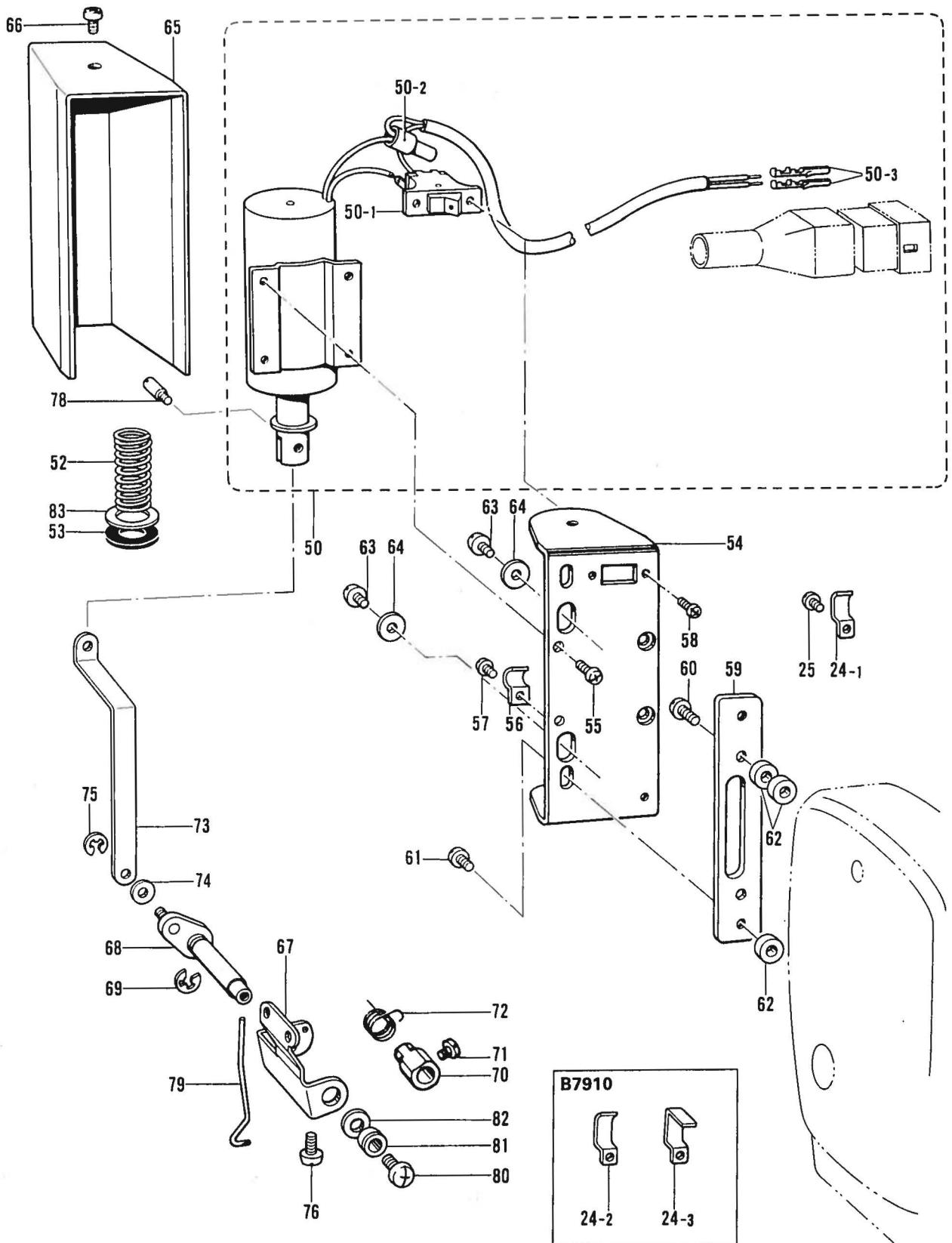
P. 糸拭イ関係/Thread wiper mechanism/Fadenwischvorrichtung/
