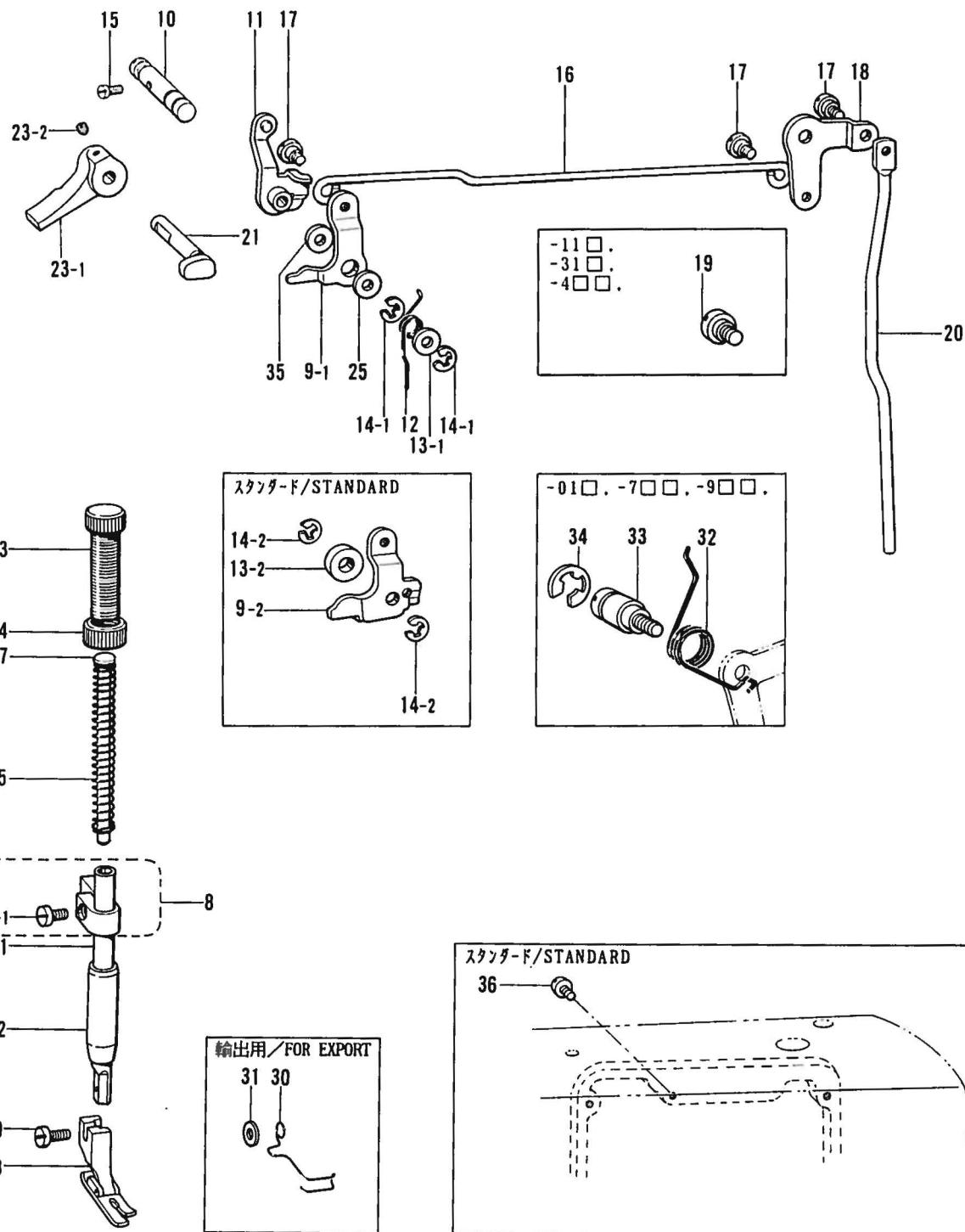
E. 押工関係/Presser foot mechanism/Stoffdrückerfuß/
