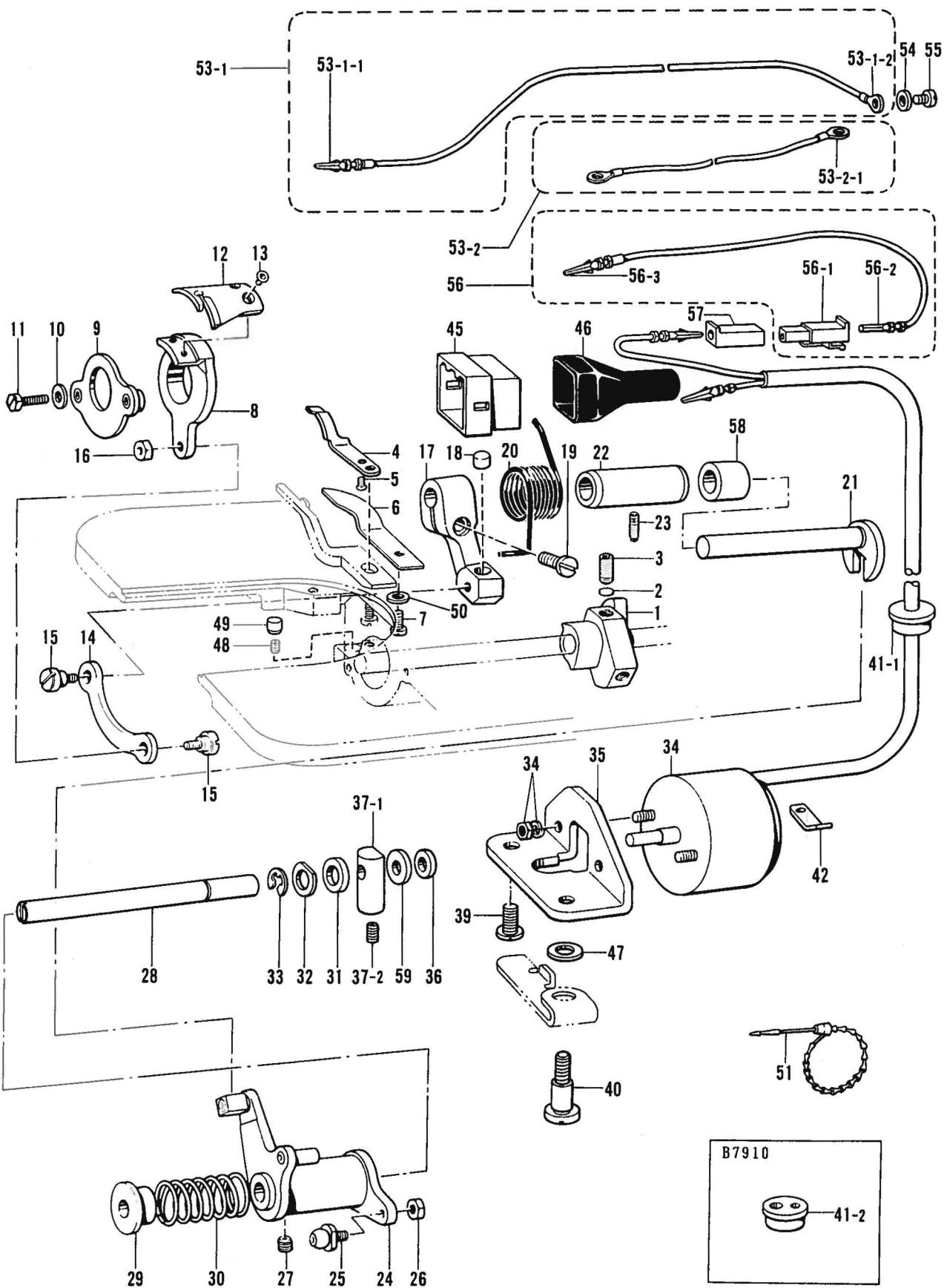
N. 糸切り関係 / Thread trimmer mechanism / Fadenabschneidevorrichtung /
