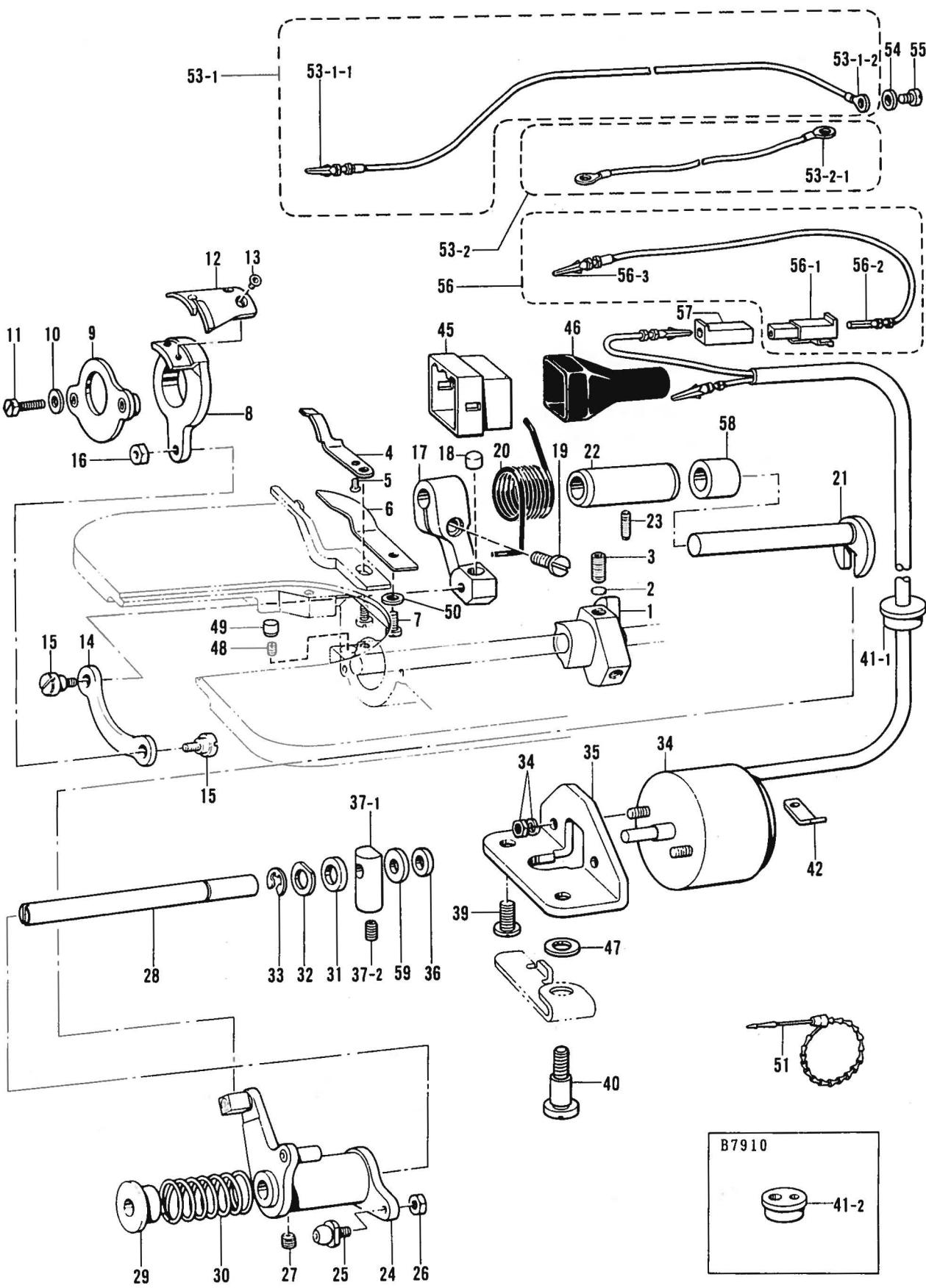
N. 糸切り関係 / Thread trimmer mechanism / Fadenabschneidevorrichtung /
