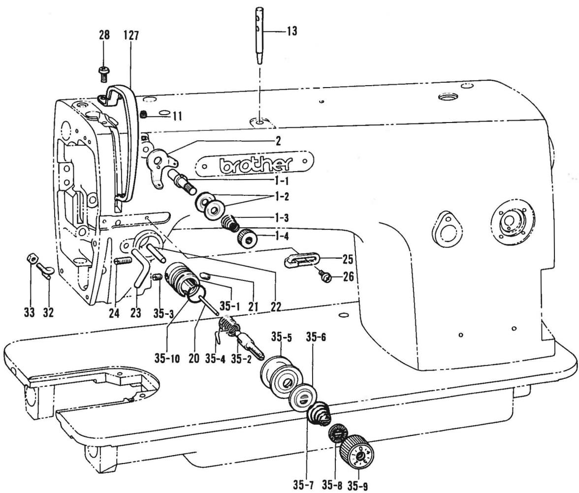
L. 糸通シ関係/Threading mechanism/Fadenführungs vorrichtung/
